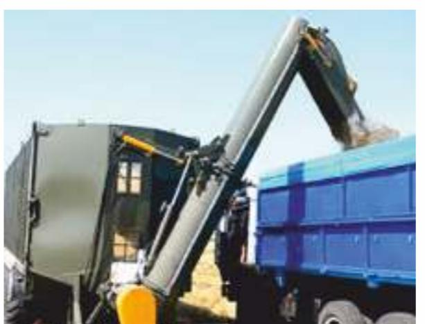
Гидравлическое изменение угла разгрузочного шнека
