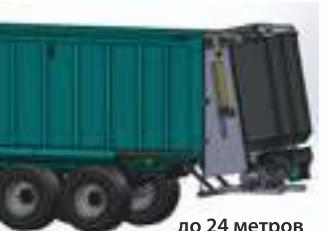
Опция: задняя стенка для внесения дефеката и куриного помета нижними тарелками (разброс до 24 м)
